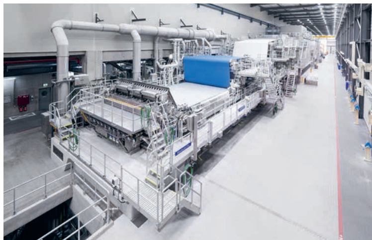
Mehr Pharma und mehr Biotechnologie: Hier entstehen neue Jobs (links). Die neue Produktionslinie 8 bei Koehler: eine der leistungsfähigsten Spezialpapiermaschinen der Welt (rechts).
